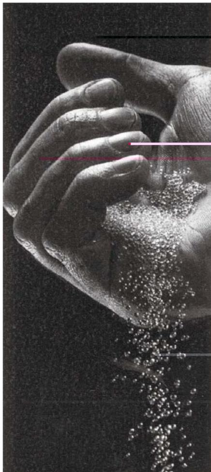
La microbille de verre est constituée de verre sodo-calcique de classe A, ne contenant pas de silice libre. Elle est utilisée pour des travaux de nettoyage, de finition et d'ébavurage.
